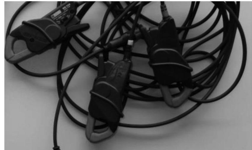
Abb.: Beispiel Strommesszange
